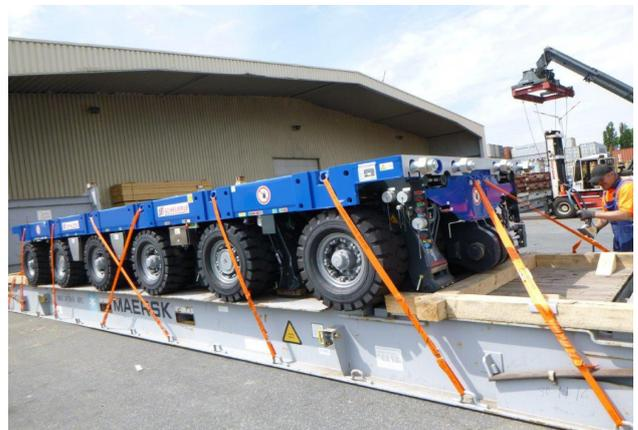
Bild 4: Laschen und Blocken der Module
