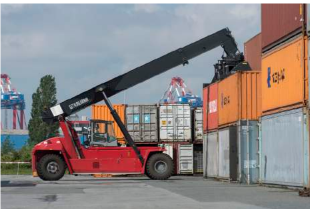
Zwei Reachstacker und vier Leercontainerstapler stehen für das Handling zur Verfügung.
